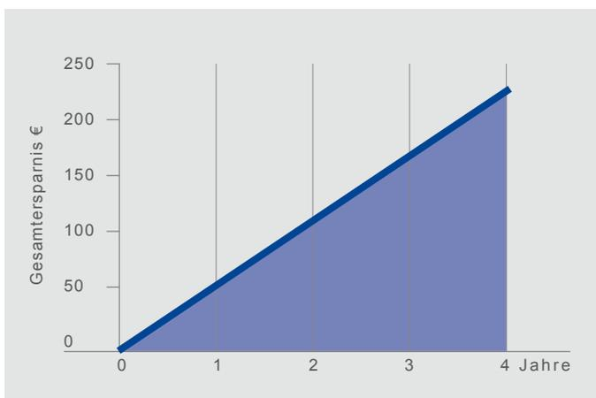
**Beispiel:** FE2owlet-ECQ-Ventilator mit ECQ-Motor im Vergleich zu traditionellen 254mm-Ventilator mit Spaltpol-Motor bei Vollzeit-Betrieb und 0,15€/KWh
