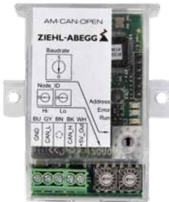
Einsteckbare Add On Module zur Funktionserweiterung der Frequenzumrichter „Icontrol Basic“ und „Fcontrol Basic“ ohne integriertes Display sowie ECblue Motoren und Ventilatoren. Mit den Erweiterungsmodulen AM-CAN-OPEN können die Geräte in CANopen Netzwerke eingebunden werden.
