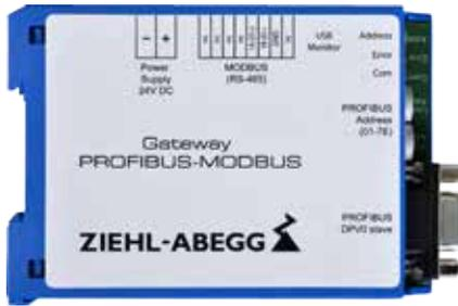
Das Gateway arbeitet als MODBUS-Master, der über PROFIBUS angesteuert wird. Bis zu 64 MODBUS-Teilnehmer können an dem Gateway angeschlossen werden.
