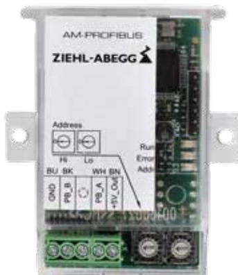
Einsteckbare Add On Module zur Funktionserweiterung der Basic Frequenzumrichter „lcontrol Basic“ und „Fcontrol Basic“ ohne integriertes Display sowie ECblue Motoren und Ventilatoren. Mit den Erweiterungsmodulen AM-PROFIBUS können die Geräte in PROFIBUS Netzwerke eingebunden werden. Zur Integration des Geräts in das PROFIBUS Netzwerk, wird eine Gerätestammdaten-Datei benötigt (GSD Datei). Diese wird über unsere Regeltechnik Support Abteilung kostenlos zur Verfügung gestellt.
